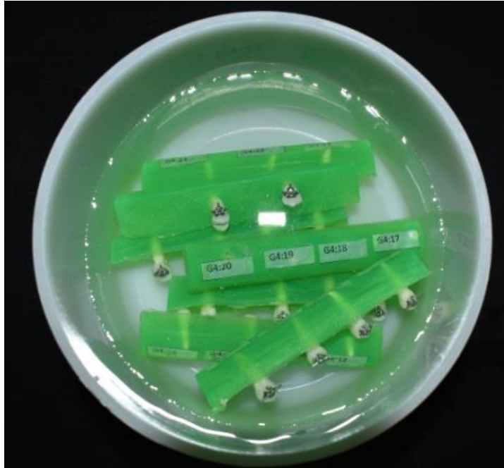
Figura 19. Almacenamiento de las pruebas en agua destilada.
